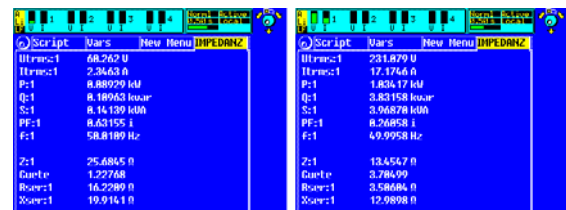
Bild 4: Anwenderdefiniertes Impedanz-Menü des Leistungsmessgerätes LMG500
